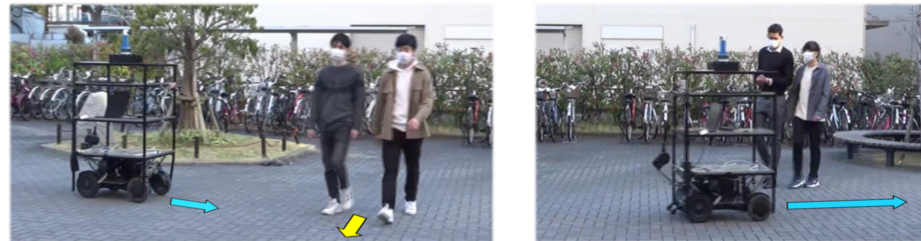
他者の先行を予測：早めに減速し、進路を譲る ロボットの先行を予測：加速し、進路を素早く空ける 迷いにくく、安心な 周辺他者に配慮した制御を実現
